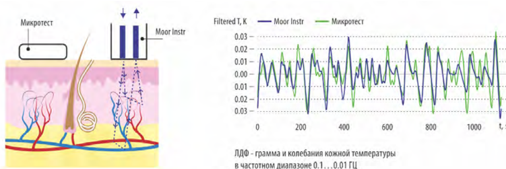
Рисунок 3 – Метод прецизионной низкоамплитудной термометрии
