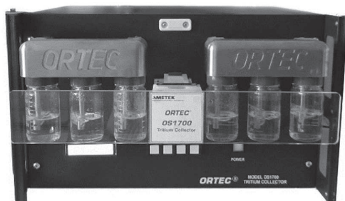
Рисунок 2 – Пробоотборное устройство коллектор трития «OS1700»
