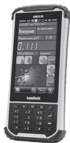
Рисунок 3 – КПК с рабочим окном программы «SimRadMobile»
