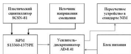
Рисунок 3 – Функциональная схема блока детектирования
